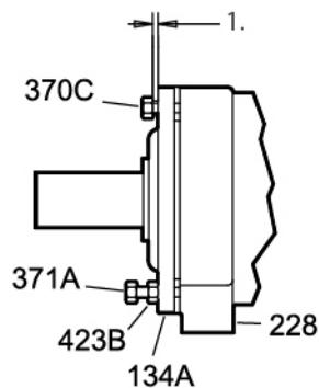
**Figure 35: Loosen jam nuts**
