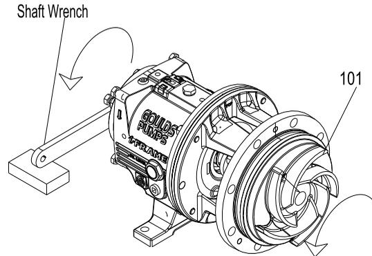
**Figure 54: Loosen impeller**
